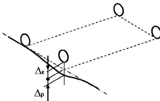
Рисунок 3 – Схема погрешности опорной базы
