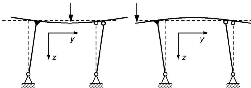
Рисунок 2 – Схемы деформаций металлической конструкции козлового крана
